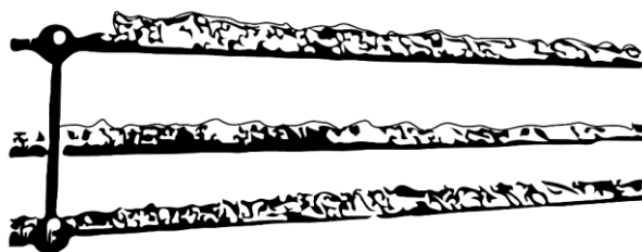
Рисунок 14 - Гололед на проводе расщепленной фазы при креплении проводов жесткими распорками
